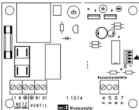
Im Auslieferungszustand befinden sich die Schalter 1,2,3 und 4 in Stellung ON. Das bedeutet eine Zeitüberwachung von 120 Minuten.
