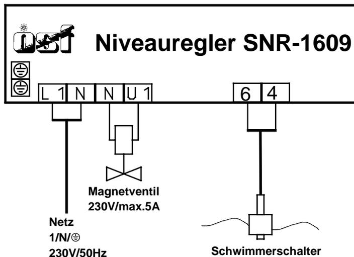
Die Leitung des Schwimmerschalters kann mit einer abgeschirmten Leitung ( $2 \times 0,75\text{mm}^2$ ) auf bis zu 50m verlängert werden. **Die Abschirmung ist mit der Klemme 4 zu verbinden.** Bitte beachten Sie, dass die Verbindung unbedingt wasserdicht ausgeführt werden muss. **Die Anschlussleitung des Schwimmerschalters darf nicht zusammen mit anderen stromführenden Leitungen verlegt werden.**
